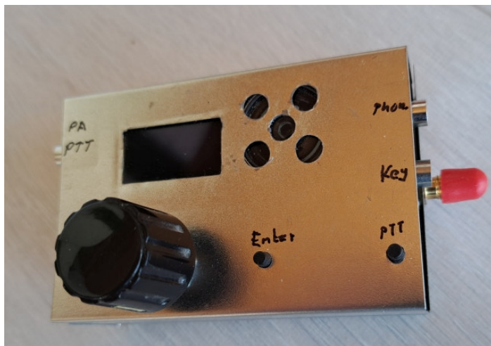
Bild oben: Mein Trx: dieser 4(tr)uSDX erhält ein Gehäuse als Abschirmung
